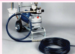
【バイブレスホース取付例】 ▲本体とエアレスホースの間に取付けます。
