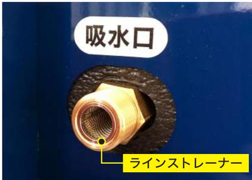
吸水ホースを機械からはずし、機械側吸水口の中に、ラインストレーナーが入っています。
