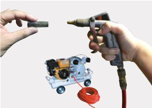
コンプレッサーのエアで飛ばします。
