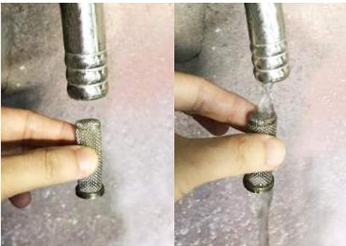
水道口の蛇口に、穴の開いている方を下にして、水道圧で流して下さい。
