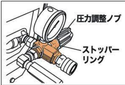
付属工具(スパナ)を使用して、アンローダノブを廻し調整して下さい。
