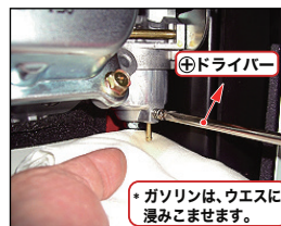
↑キャブレター下の水抜きネジをまわして水を抜く。
