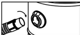
↑図のようにホースコネクタを吸気口に挿入し、コネクタがしっかり締まっているか確認してください。
