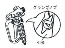
引金を引いた状態でノブの矢印がガン先を 向くように回しながら引金を離します。再 度引き直せば自動的に解除されます。
