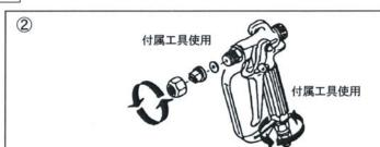
ノズルチップとガンフィルターの取り外しは図の様にして下さい。ノズルチップが詰まった場合はノズルチップを外してエアー等で逆方向から吹き付けて除去して下さい。取付けの際にはパッキンが入っているか確認してしっかり締め付けて下さい。
