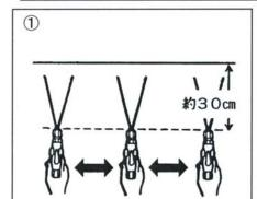
ガンは塗装面に向けて、約30cmの感覚を保 ち、一定の速さで平行に移動します。
