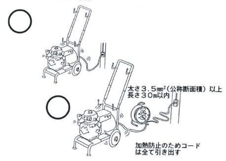
●無理な運転を続けるとモーターの焼損保護の為、過負荷保護器が働きモーターが停止します。この場合、電源電圧が低すぎる事が主な原因です。電源電圧を改善するか塗料圧力を下げてお使いください。過負荷保護器のリセットボタンは、スイッチを「OFF」にしてから1~2分後押し込んでください。
