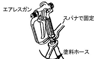
※塗料ホースは付属工具によって確実に締付けて下さい。圧力がかかります。緩んでいると漏れの原因になります。
