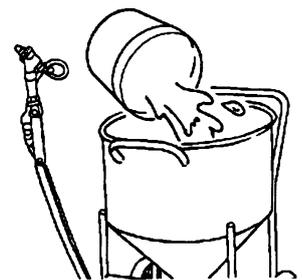
！ この時、切替スイッチが「吸込・洗浄」であるため、玉吹きガンにエアーを流さなくてもポンプは作動します。余分な跳ね返りをなくすためにもコンプレッサー側のコックを閉じたままにしておくか、玉吹きガンのエアー調整バルブを絞った状態で運転させてください。
