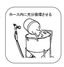
! この時、切替スイッチが「吸込・洗浄」であるため、玉吹きガンにエアーを 流さなくてもポンプは作動します。余分な跳ね返りをなくすためにもコンプ レッサー側のコックを閉じたままにしておくか、玉吹きガンのエアー調整バ ルブを絞った状態で運転させてください。
