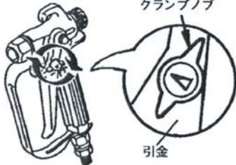
引き金を引いた状態でノブの矢印がガン先を向くように回しながら引き金を離します。再度引き直せば自動的に解除されます。
