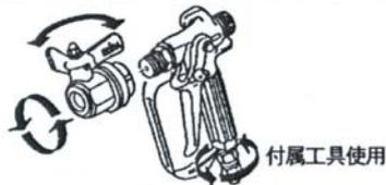
ノズルチップとガンフィルターの取り外しは図の様にしてください。ノズルチップが詰まった場合はノズルチップを外してエア等で逆方向から吹き付けて除去してください。取り付けの際にはパッキンが入っているか確認してしっかり締め付けてください。
